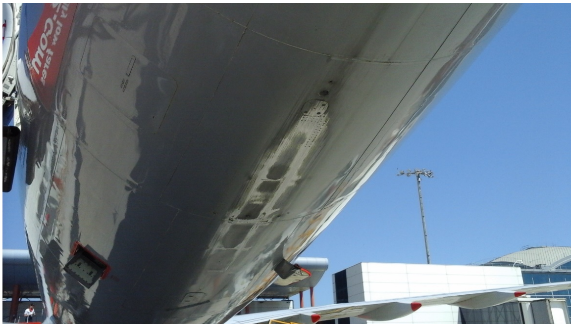
Figura 1. Daños en la parte inferior trasera del fuselaje.
