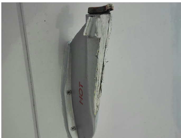
Figura 2. Detalle de daños en antena VHF y sonda de drenaje.
