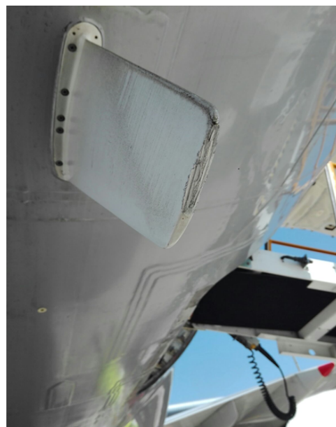
Figura 2. Detalle de daños en antena VHF y sonda de drenaje.
