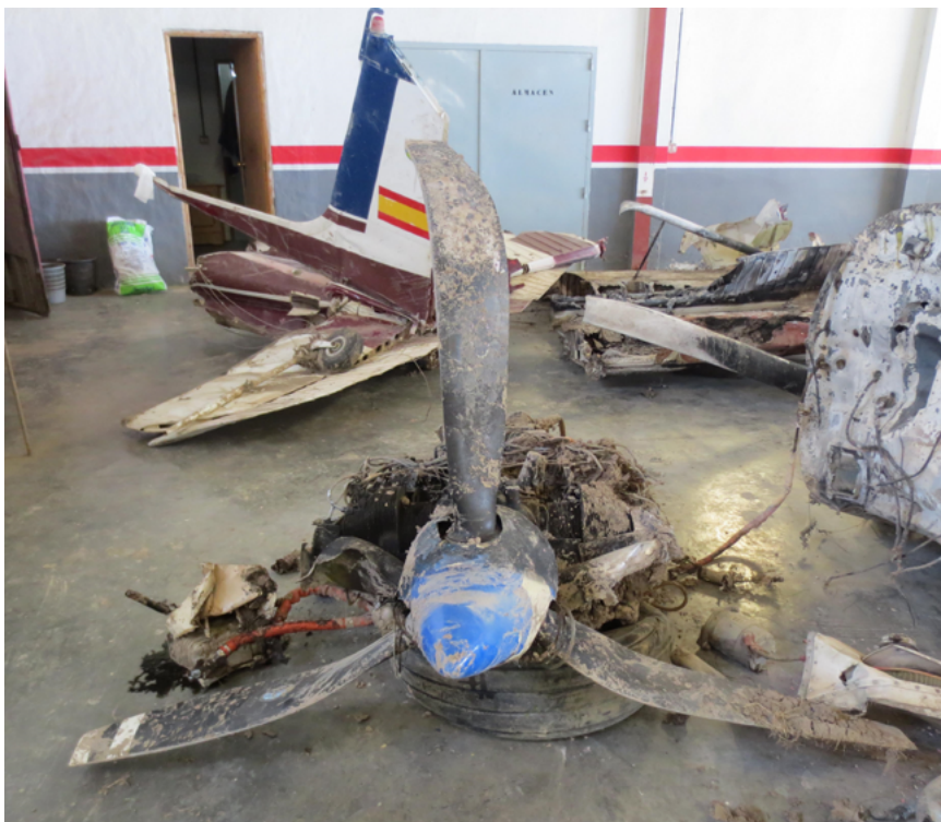
Figura 3. Estado de la hélice tras el evento.
