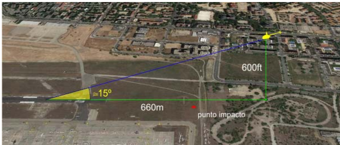
Fig. 7.- Detalle pto. inicio y trayectoria teórica de autorrotación
