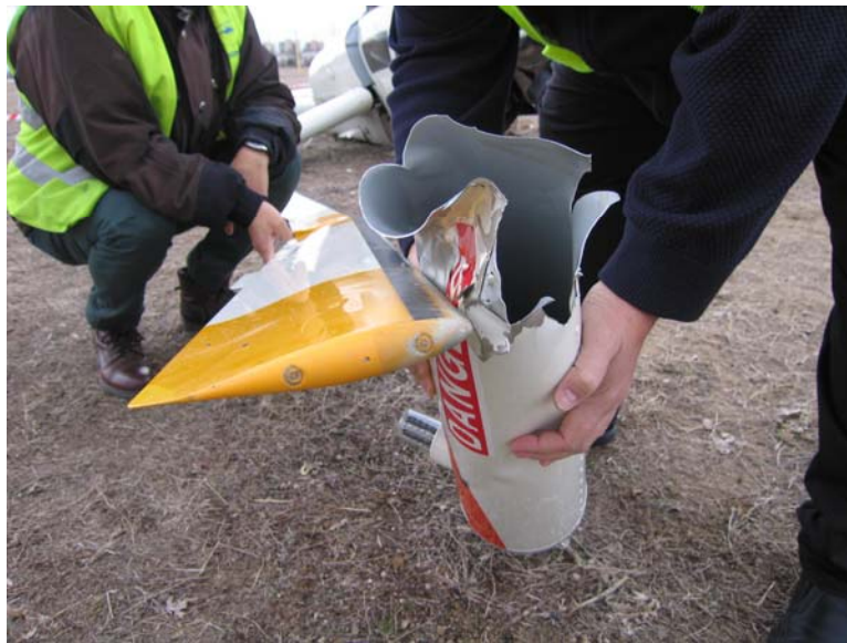
Fig. 5.- Detalle impacto de pala con cono de cola
