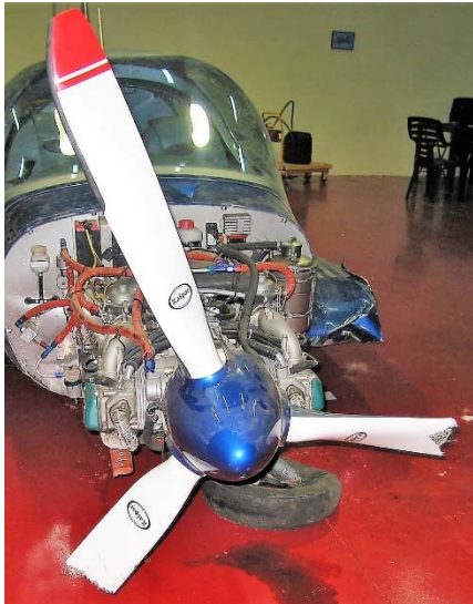
Fotografía 10: Morro y hélice dañados
