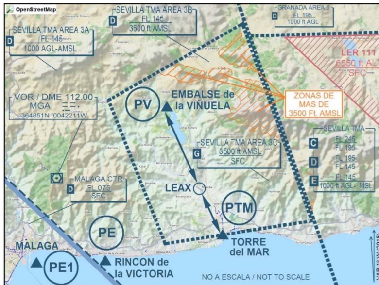
Figura 2. Carta de aproximación visual del aeródromo de la Axarquía
