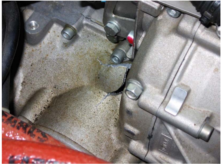
Fotografía 11: Rotura en cuerpo de motor
