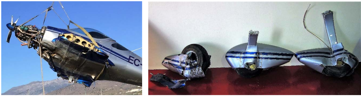
Fotografías 4 y 5. Tren de aterrizaje principal y de morro desprendido
