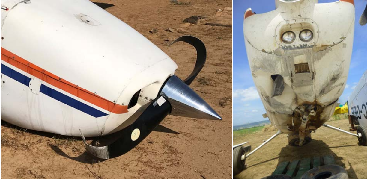
Figura 4. Daños a la aeronave
