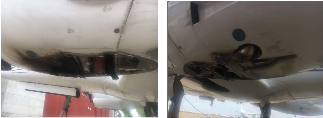
Ilustración 2: Daños en la parte inferior del fuselaje
