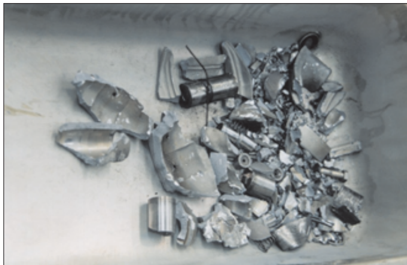
Figura 1. Restos encontrados en el cárter de aceite.
