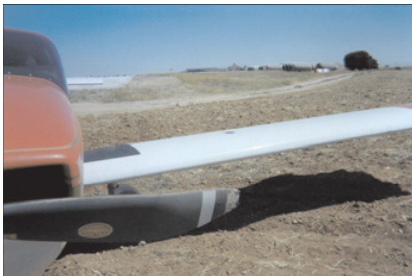
Fotografía 1. Daños en la hélice.
