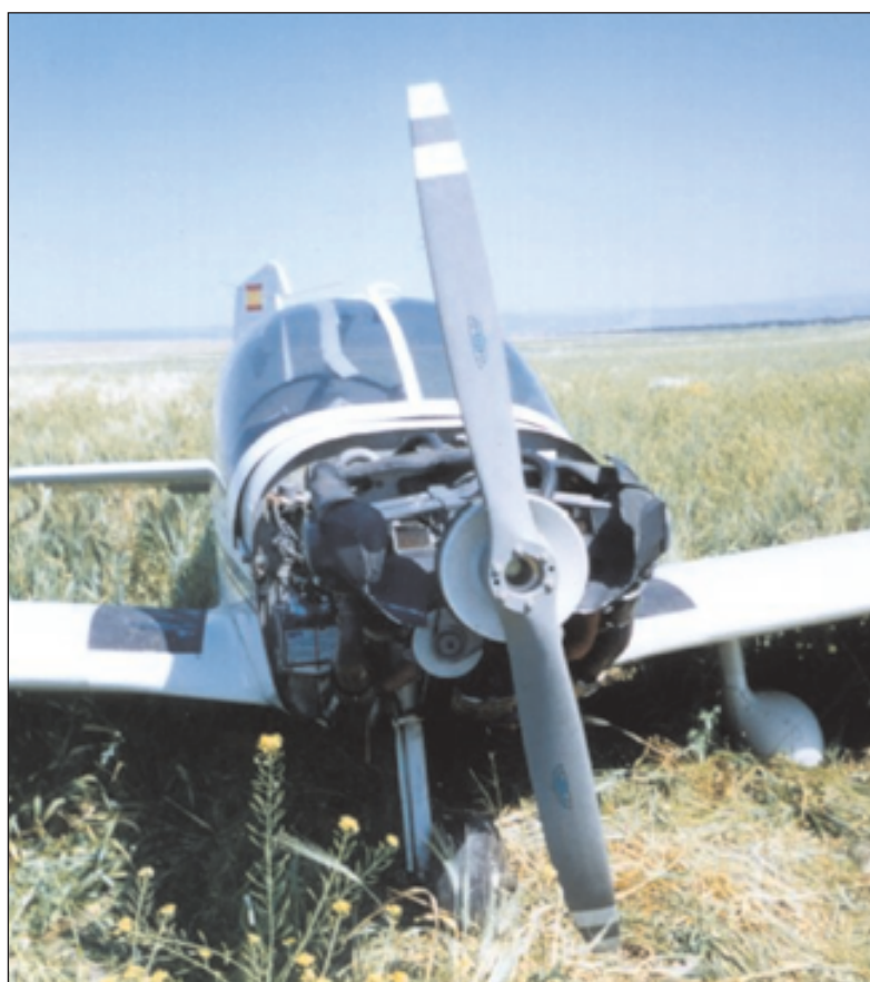
Figura 4. Pala de la hélice deformada.
