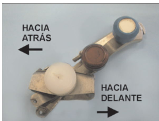
Figura 5. Posición para el despegue
