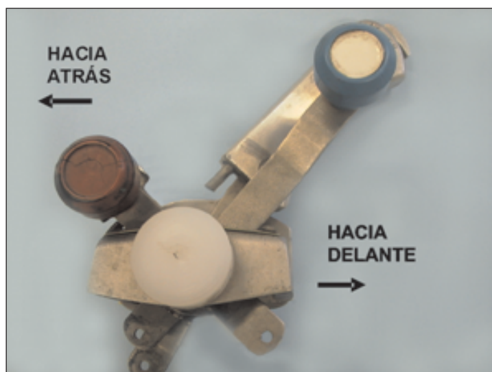
Figura 6. Posición de los mandos después del accidente
