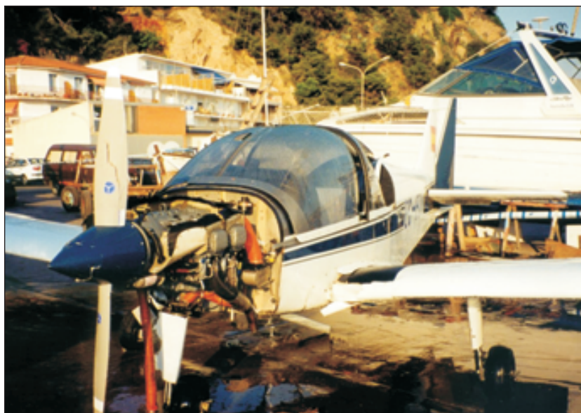
Fotografía 2. Daños en la hélice
