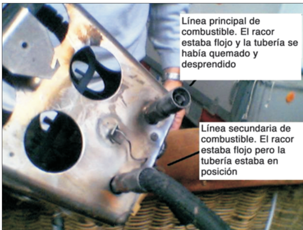
Figura 2. Estado del quemador tras el accidente
