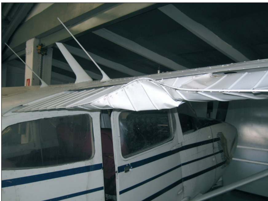
Figura 2. Deformación del flap
