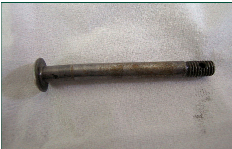
Foto 2. Tornillo de unión del «link assembly – nose gear downlock» al sobrecentro
