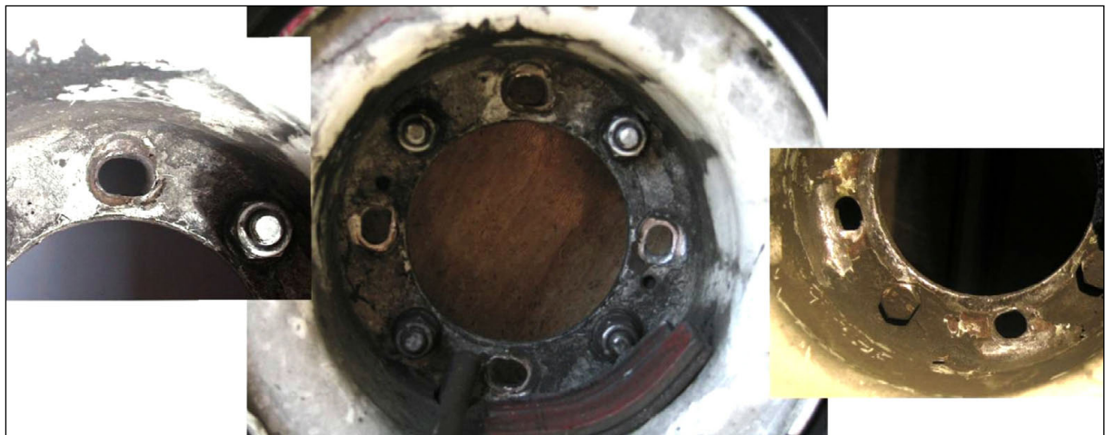
Foto 3. Detalles de la deformación de los orificios en la llanta
