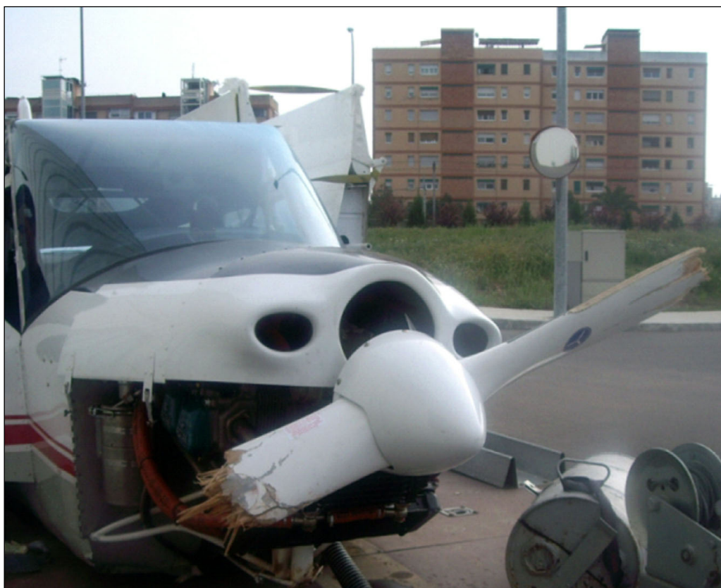
Figura 2. Fotografía del estado de la hélice
