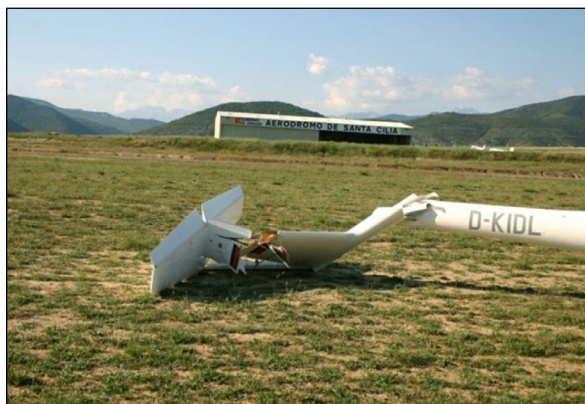
Figura 1. Daños en la aeronave D-KIDL
