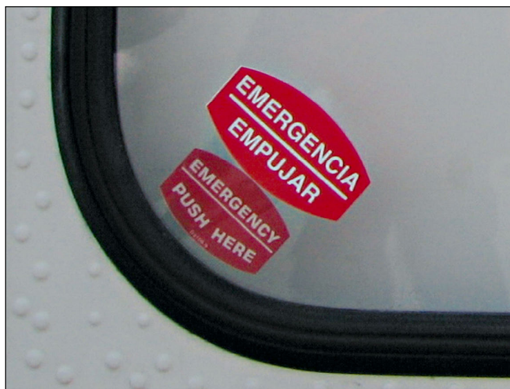
Figura 3. Pegatinas situadas en las esquinas inferiores de las ventanillas de emergencia
