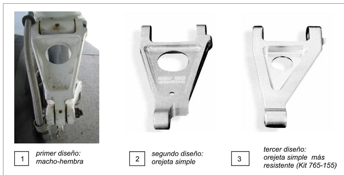
Figura 3. Diseños de la tijera del tren principal
