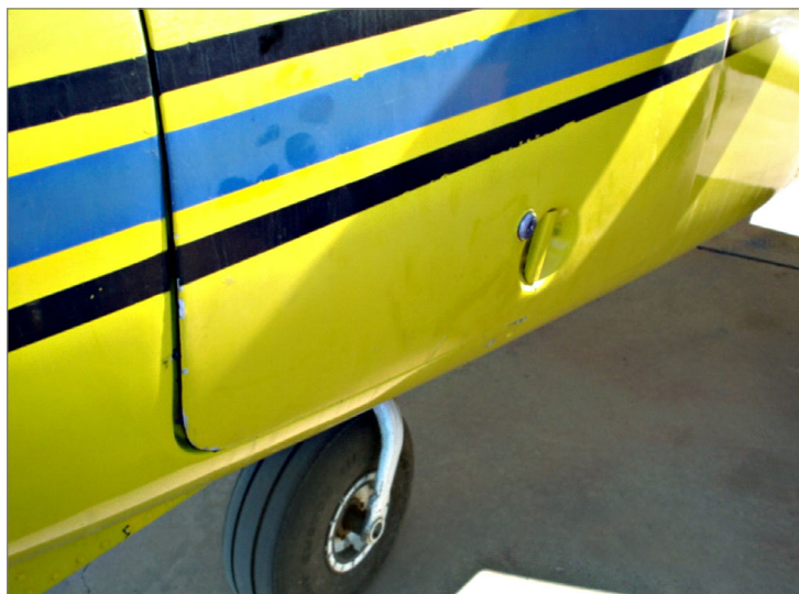
Foto 2. Puerta similar de otra aeronave con su manilla en posición abierta
