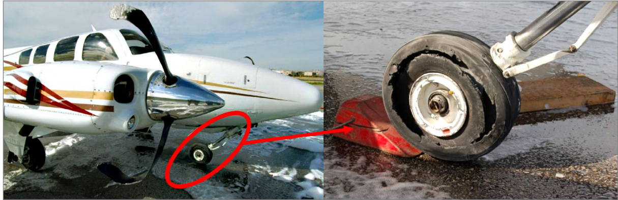
Foto 3. Detalle de la pata de morro
