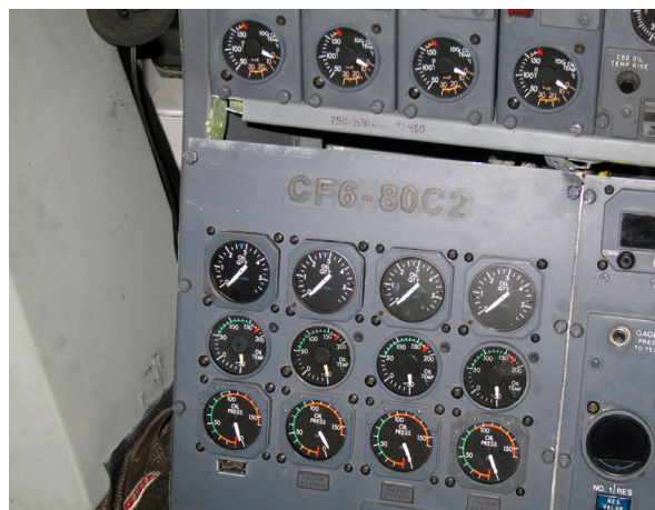
Figura 3. Panel del mecánico de a bordo
