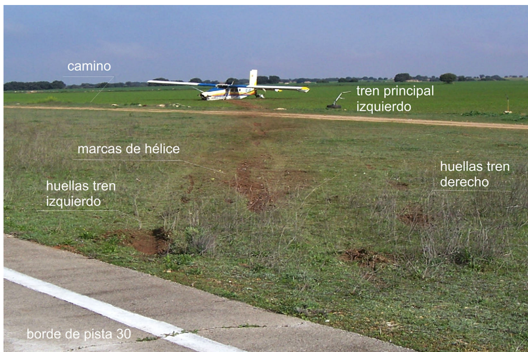
Figura 2. Huellas y posición final de la aeronave
