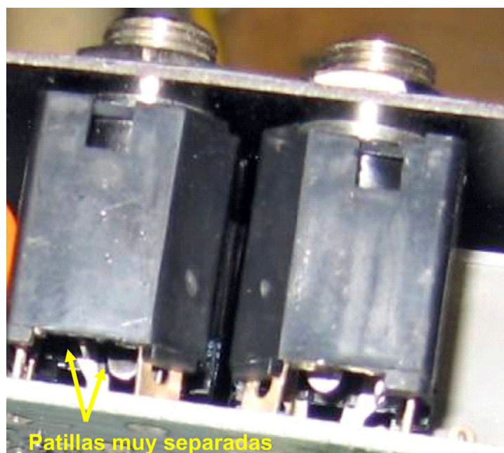
Figura 10. Patillas de la conexión hembra del micrófono del piloto
