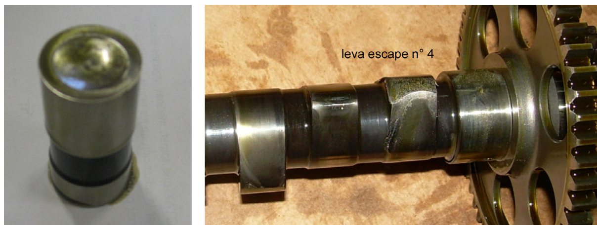
Figura 2. Taqué hidráulico y leva del árbol de levas de la válvula de escape del cilindro n.º 4 de la aeronave EC-IZC
