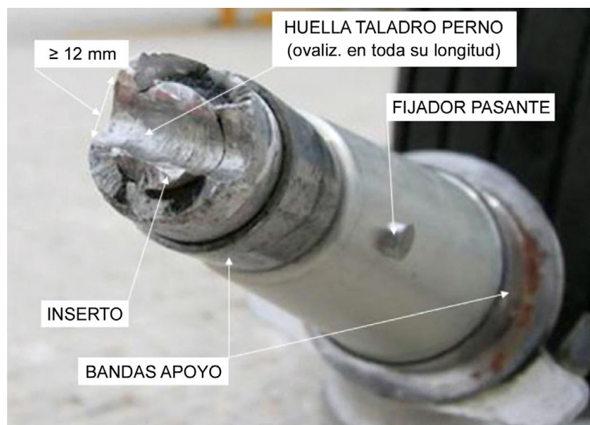
Figura 5. Vista del vástago y su rotura
