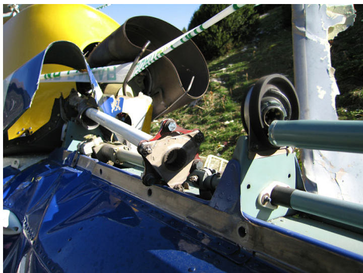
Foto 4. Zona de rotura del eje de transmisión de potencia al rotor antipar
