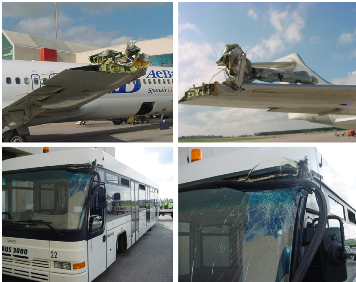
Foto 1. Daños en la aeronave y jardinera
