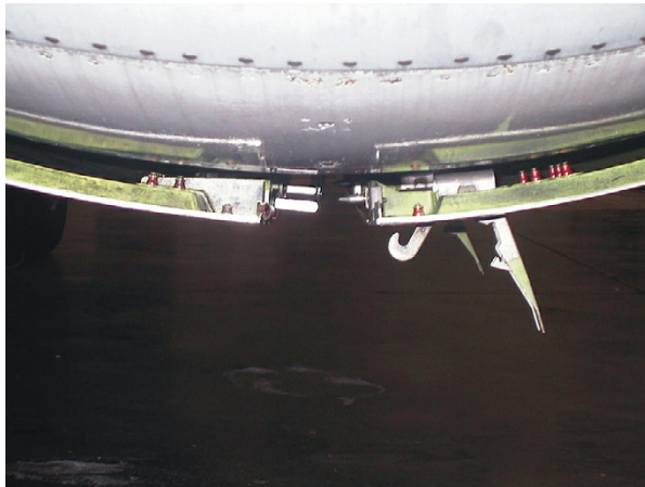
Figura 3. Capós cerrados y pestillos sin enganchar
