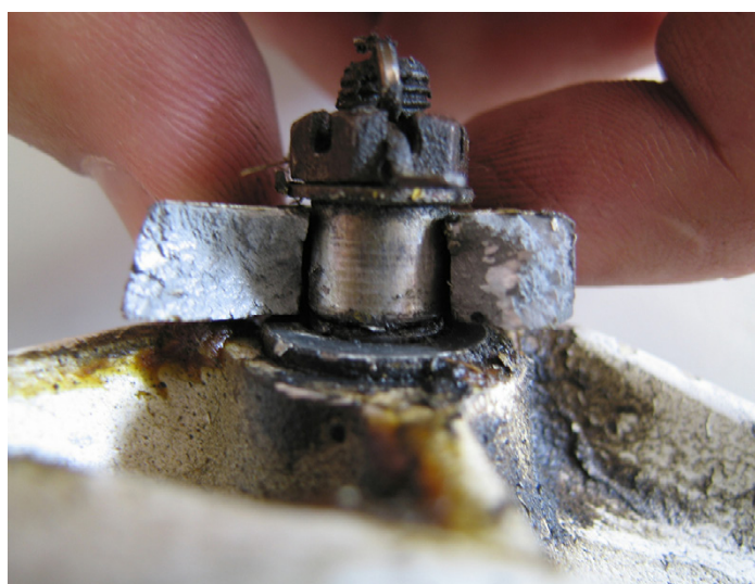
Figura 3. Rotura de la orejeta del herraje
