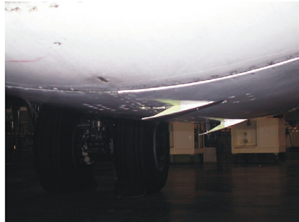
Figura 4. Pestillos enganchados y sin asegurar
