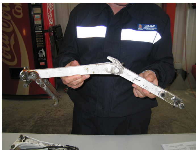
Figura 5. Estado del tornapunta después del incidente
