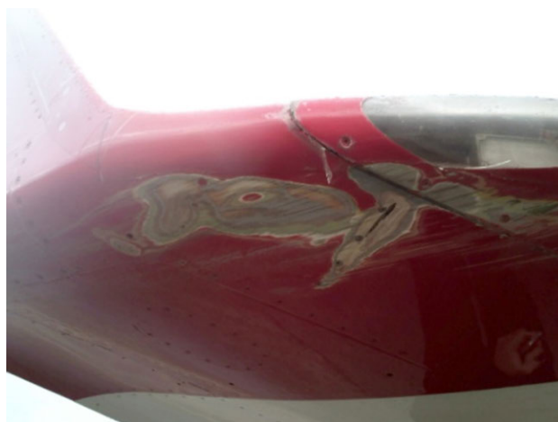
Figura 2. Punta del ala dañada
