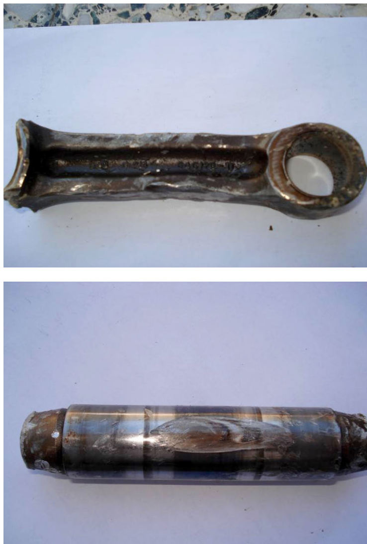
Figura 4. Pieza de biela y bulón hallados en el recorrido de aterrizaje
