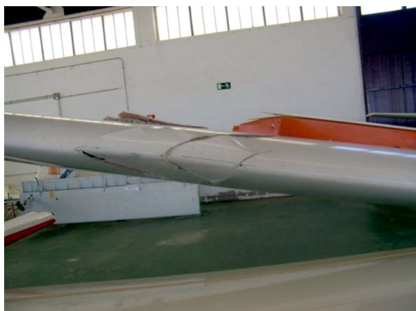
Figura 1. Cortes producidos por la hélice en el plano del velero
