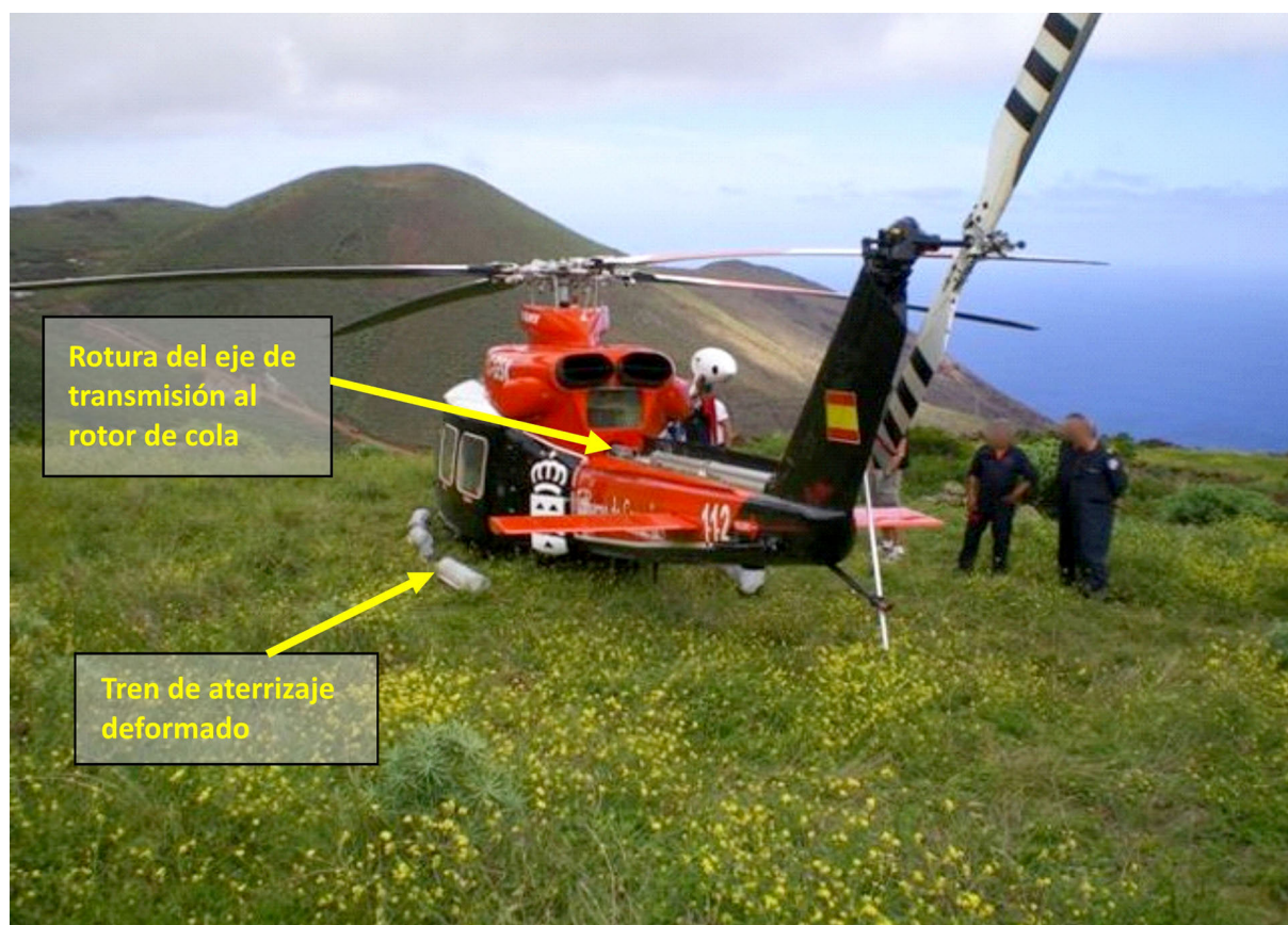
Figura 1. Daños en el helicóptero
