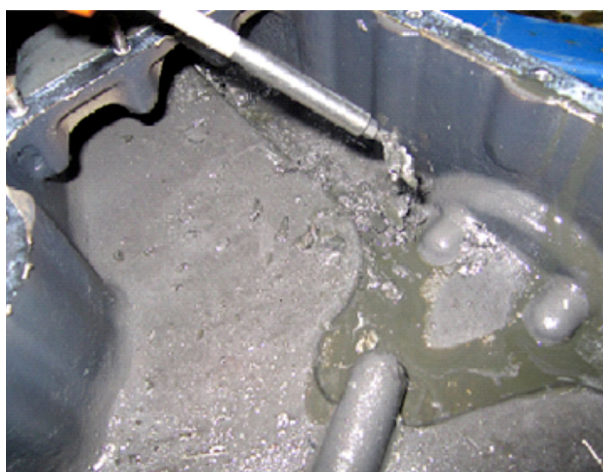
Figura 4. Partículas y virutas metálicas en el cárter
