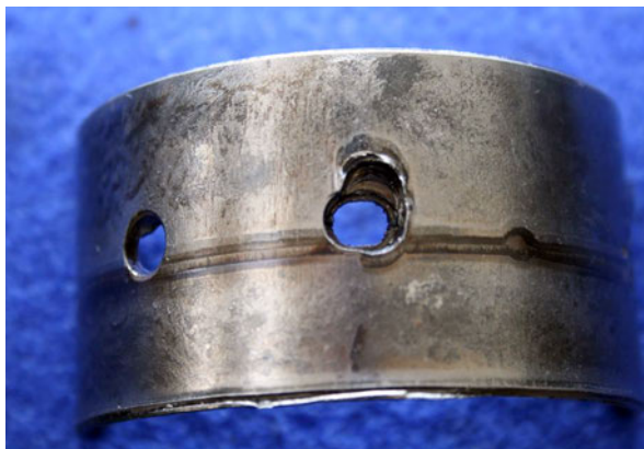
Figuras 4 y 5. Deformaciones en semicojinete central y semicárter
