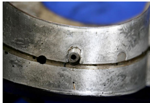
Figuras 4 y 5. Deformaciones en semicojinete central y semicárter
