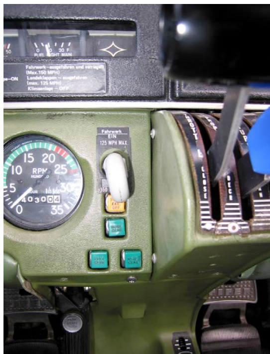
Figura 2. Foto de la palanca de tren con las luces asociadas
