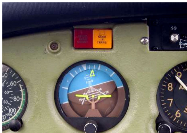
Figura 3. Foto de las luces de tren en tránsito (amarilla) y de posición de tren inseguro (roja)
