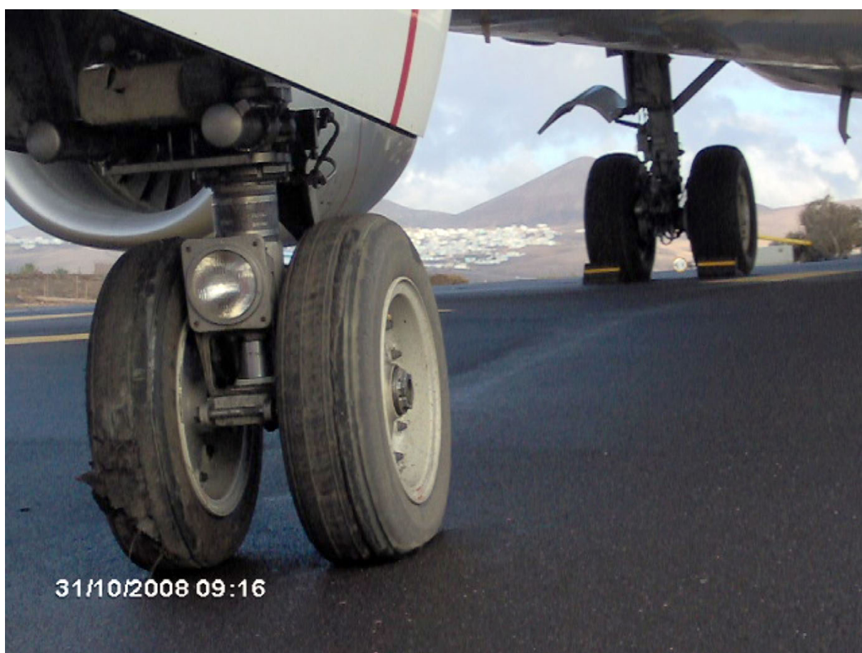
Figura 2. Daños en pata de morro del tren de aterrizaje
