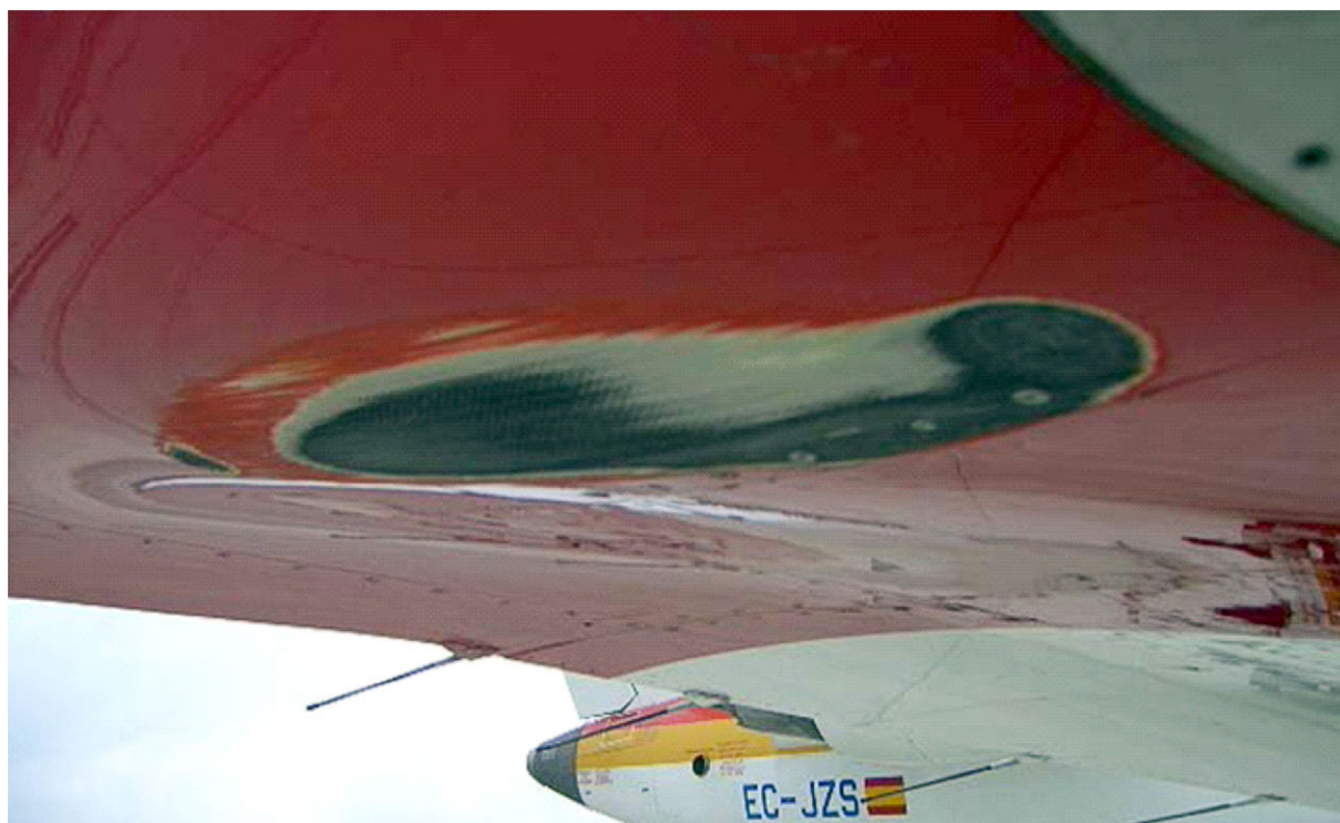
Figura 2. Rasponazo en intradós del plano derecho
