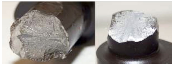
Figura 10. Detalle de la rotura del árbol de levas
