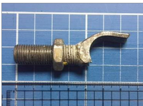
Figuras 7 y 8. Fragmento del resto de la orejeta rota
