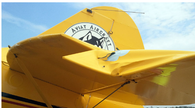
Figura 2. Daños en el timón de profundidad
