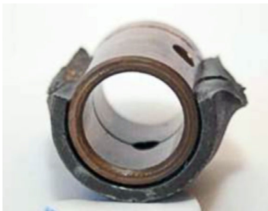
Figura 8. Desalineación de los orificios de lubricación
