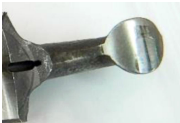
Figura 9. Planos de contacto del patín del balancín de escape dañado
