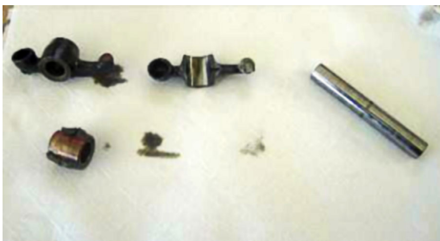
Figura 6. Balancines y eje del cilindro n.º 2
