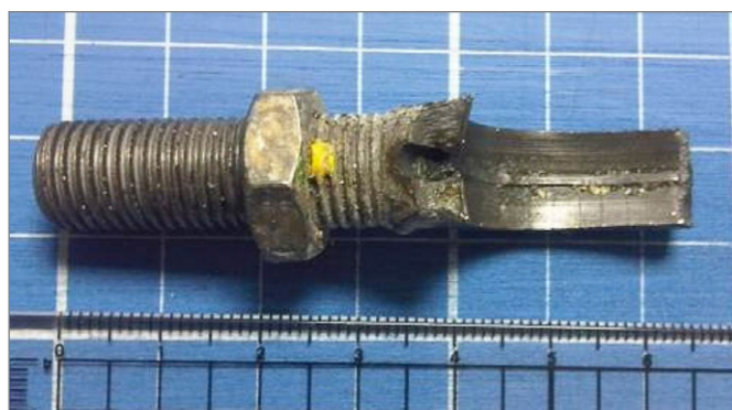
Figuras 7 y 8. Fragmento del resto de la orejeta rota
