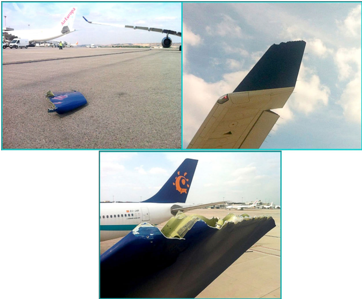
Figura 4. Daños en el «winglet» EC-JHP
