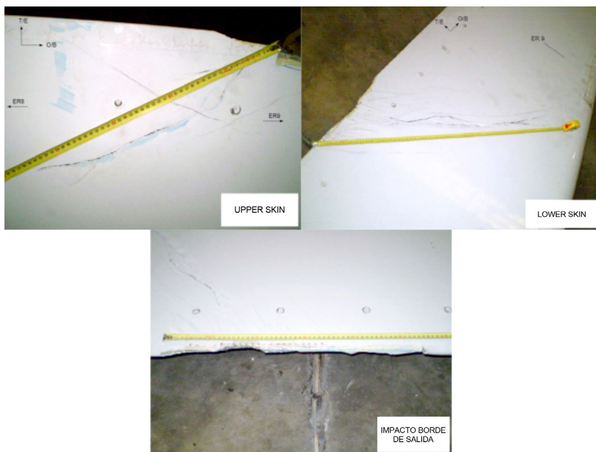
Figura 3. Daños en timón de profundidad EC-JQQ
