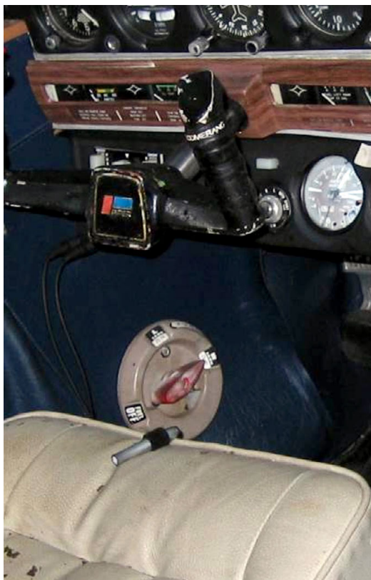
Figura 2. Llave selectora de combustible
