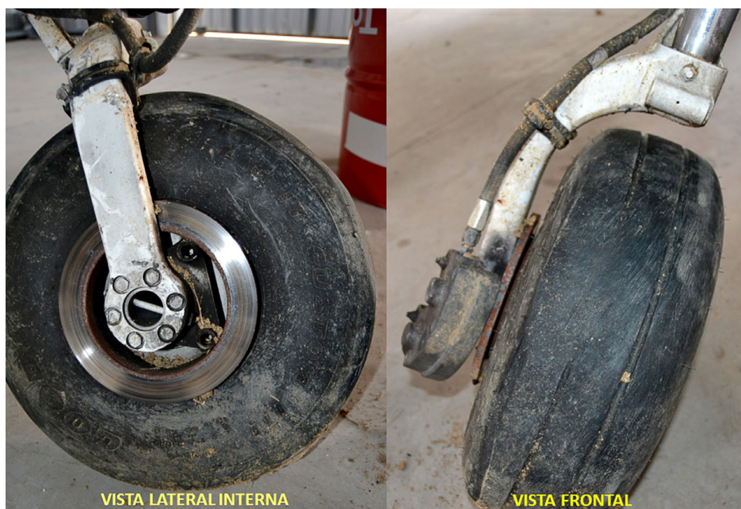
Figura 2. Huellas de desgaste en la cubierta izquierda
