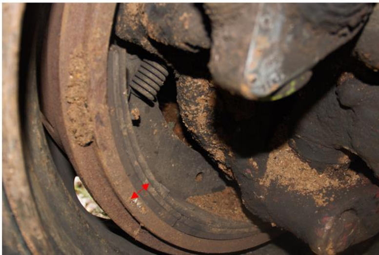
Kampas rem masih tebal & Celah kampas rem dgn tromol 1,7 – 2,5 mm
