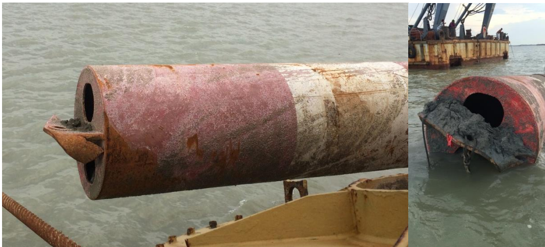
Gambar I-31: kerusakan pada eye patch spud pile
