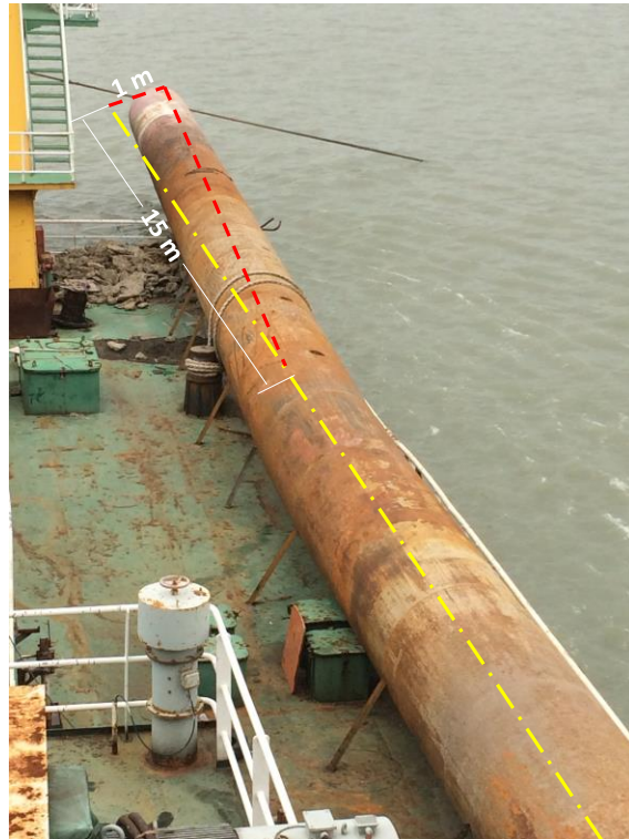
Gambar I-32: bengkokan yang terjadi pada spud pile pada saat ditemukan
