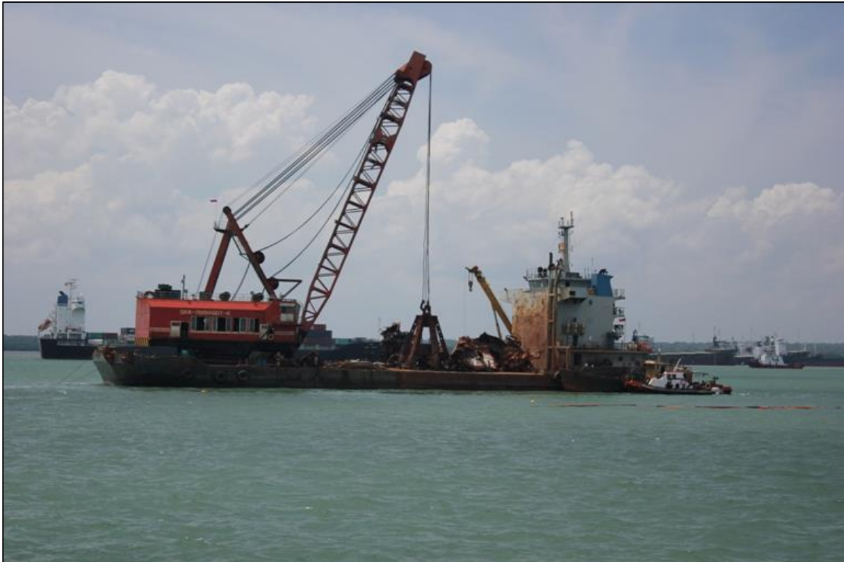
Gambar I-33: Crane kerja untuk mengangkat badan kapal
