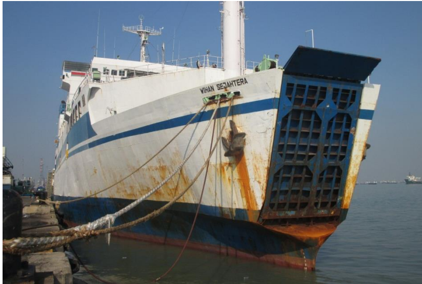
Gambar I-4: Kondisi pintu rampa haluan kapal yang sebelumnya terdapat di sisi kanan haluan.
