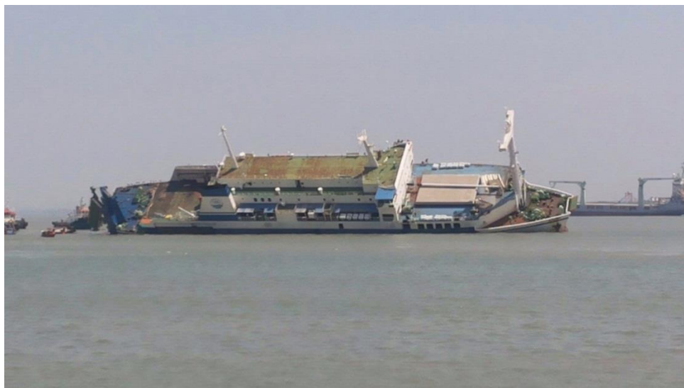
Gambar 0-5: kondisi kapal ketika sudah mengalami penambahan kemiringan pada sekitar 15 menit setelah terjadi getaran
