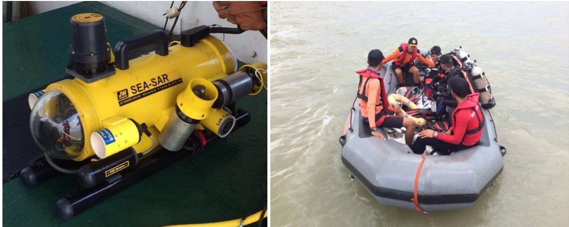
Gambar I-18: Pemeriksaan bawah air dengan menggunakan ROV dan penyelaman
