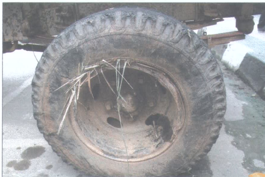
Gambar 2. kondisi velg ban kiri belakang truk yang mengalami benturan
