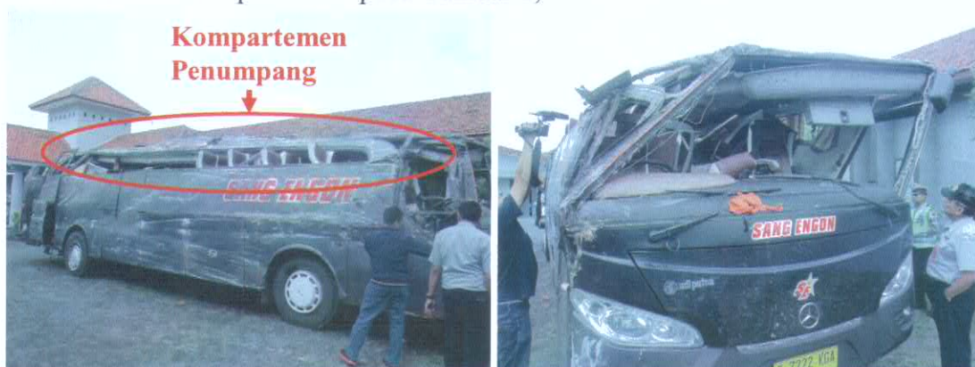
Gambar 1. Mobil Bus B-7222-KGA yang mengalami kecelakaan. Gambar kiri adalah kondisi mobil bus bagian kompartemen penumpang yang mengalami kerusakan parah akibat benturan dengan tebing. Gambar kanan adalah kondisi mobil bus dilihat dari sisi depan kendaraan.
