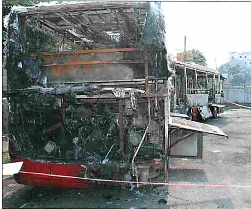
Gambar 2. Kondisi bagian belakang mobil bus setelah terbakar
