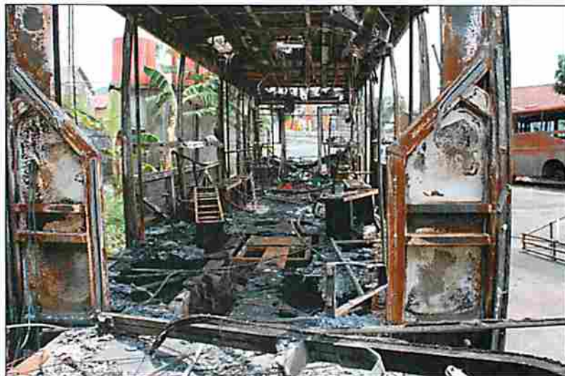
Gambar 3. Kondisi bagian dalam mobil bus setelah terbakar
