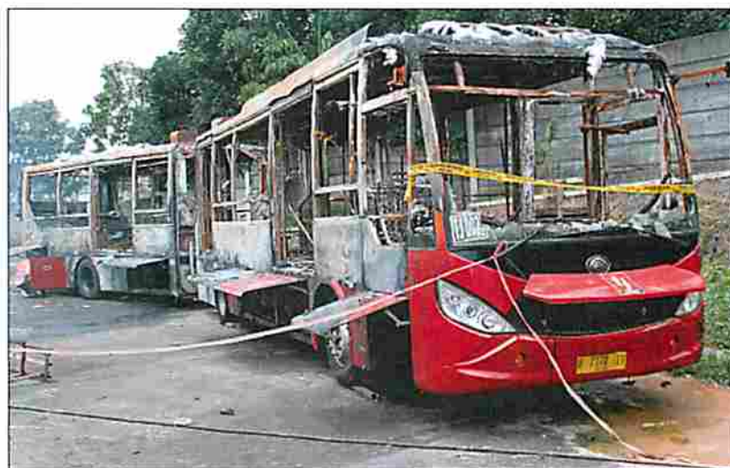
Gambar 4. Kondisi bagian depan mobil bus setelah terbakar
