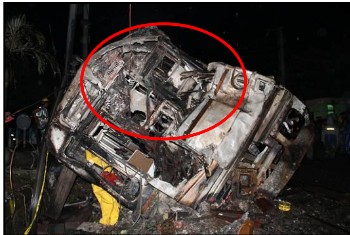
Gambar 2. Posisi kereta pertama K.1 1011 25 meter dari titik tabrakan, anjlok dan terbakar setelah menabrak truk semi trailer tanki. Tanda lingkaran merah menunjukkan impact point benturan dengan mobil tanki.
