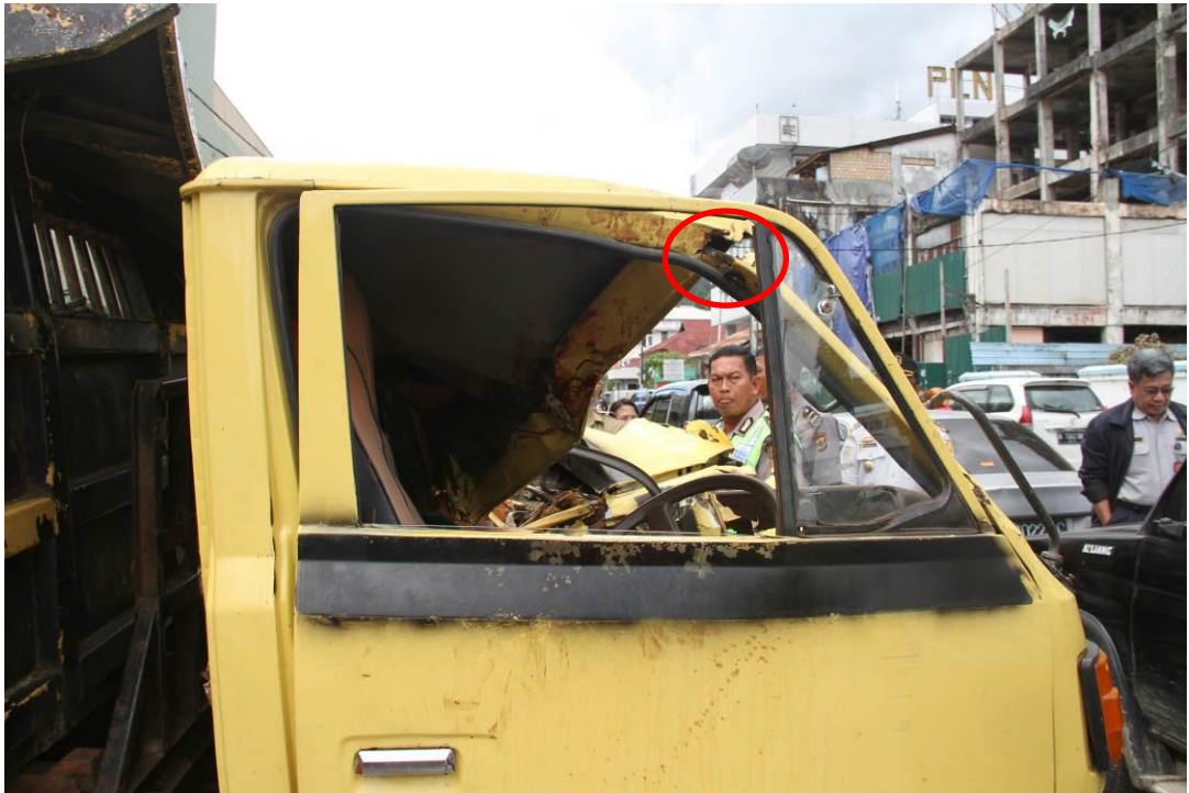
Gambar 21. Korosi pada superstructure kabin.
