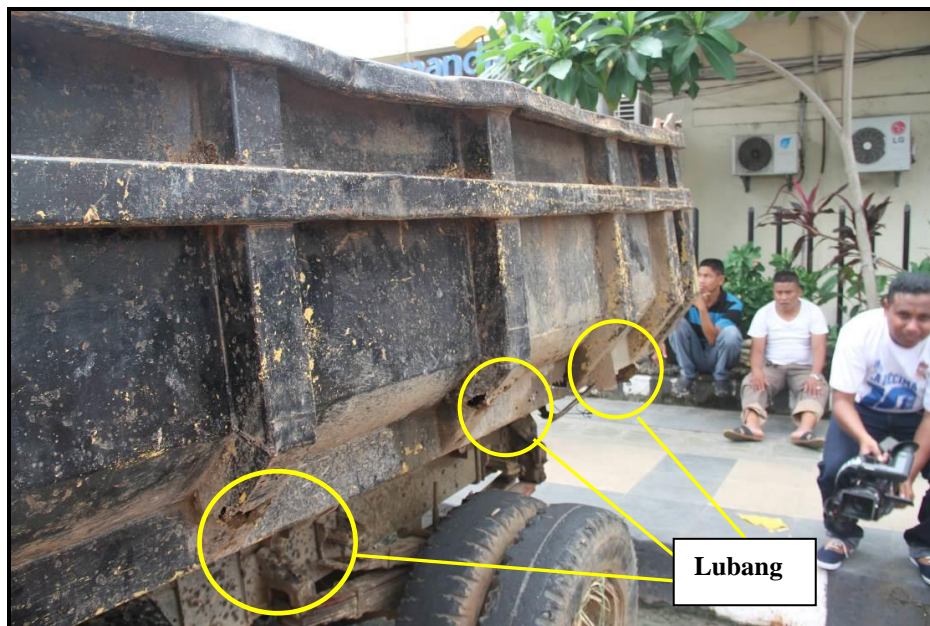
Gambar 19. Korosi pada bak kendaraan.
