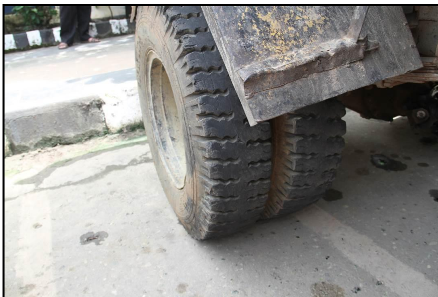
Gambar 18. Kondisi ban belakang sebelah kanan mobil barang dump truck .
