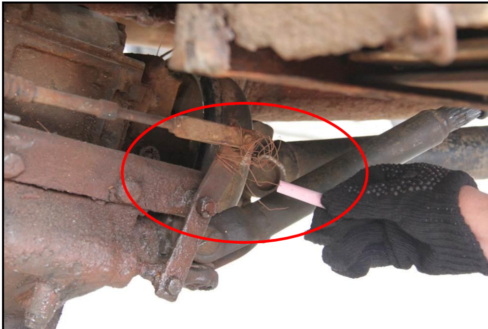
Gambar 23. Tuas penghubung PTO diikat dengan kawat.
