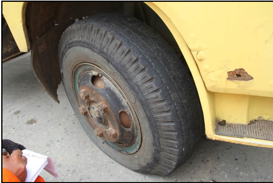
Gambar 14. Kondisi ban depan sebelah kanan mobil barang dump truck .
