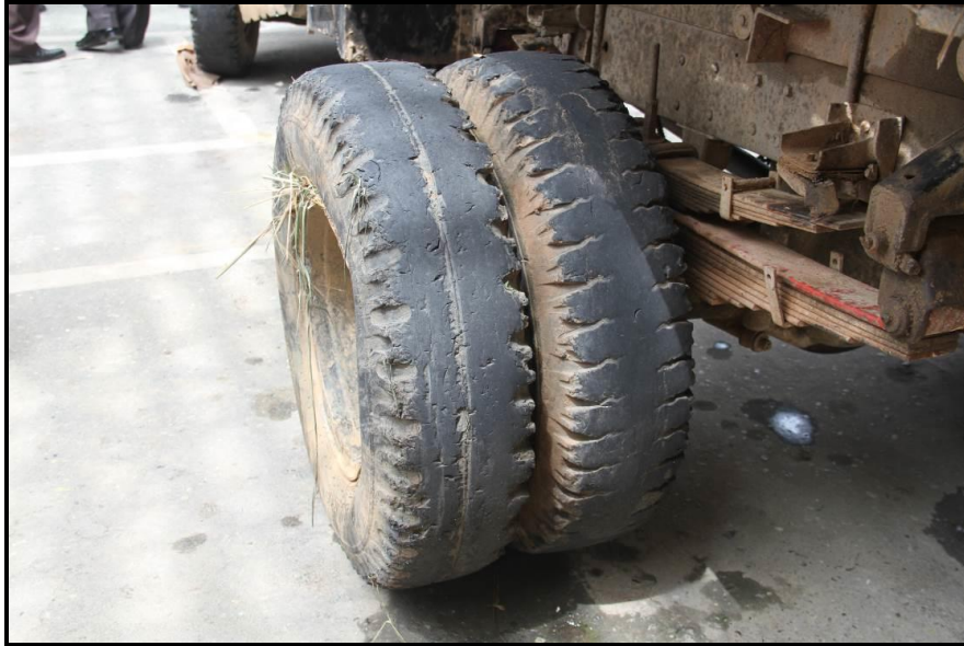
Gambar 17. Kondisi ban belakang sebelah kiri mobil barang dump truck .
