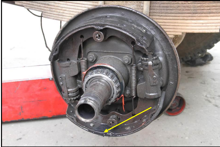
Gambar 16. Kebocoran minyak rem pada rem tromol roda bagian belakang sebelah kiri.
