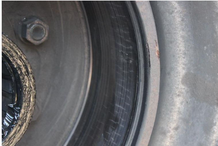
Gambar 25. Keausan pada tromol rem.
