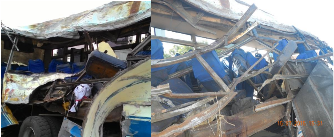
Gambar 22. Temuan korosi pada superstructure mobil bus.
