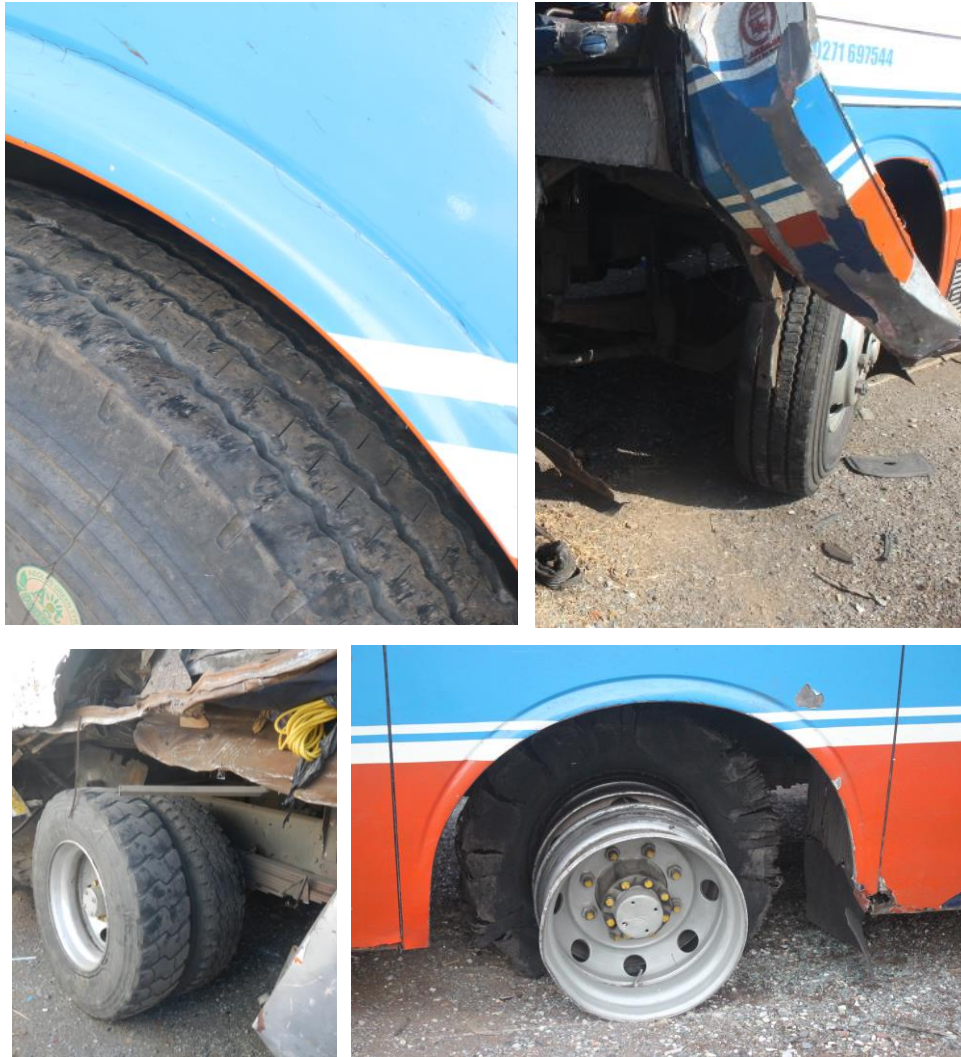
Gambar 28. Kondisi ban Mobil Bus AD-1543-CF. Gambar kiri-atas menunjukkan ban kanan-depan. Gambar kanan-atas menunjukkan ban kiri-depan. Gambar kiri-bawah menunjukkan ban kanan-belakang. Gambar kanan-bawah menunjukkan ban kiri-belakang.
