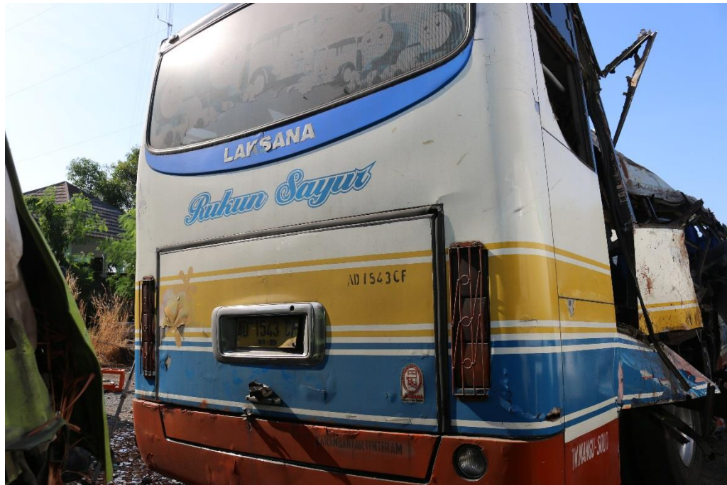
Gambar 7. Kondisi bagian belakang Mobil Bus AD-1543-CF setelah terjadinya kecelakaan.
