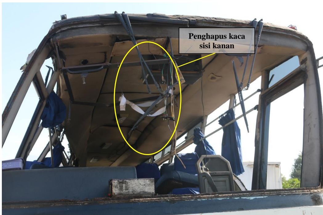
Gambar 10. Kerusakan kelengkapan kendaraan di bagian depan Mobil Bus AD-1543-CF.
