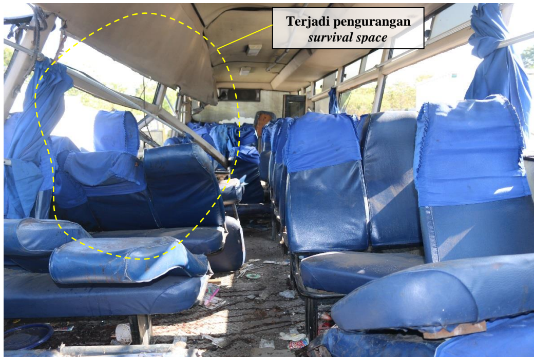
Gambar 11. Kondisi kompartemen penumpang Mobil Bus AD-1543-CF setelah terjadinya kecelakaan dilihat dari bagian depan mobil bus.
