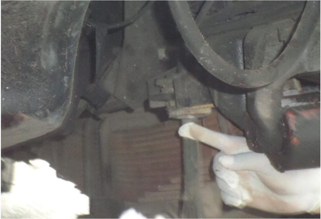
Gambar 30. Karet stabilizer yang tidak original.
