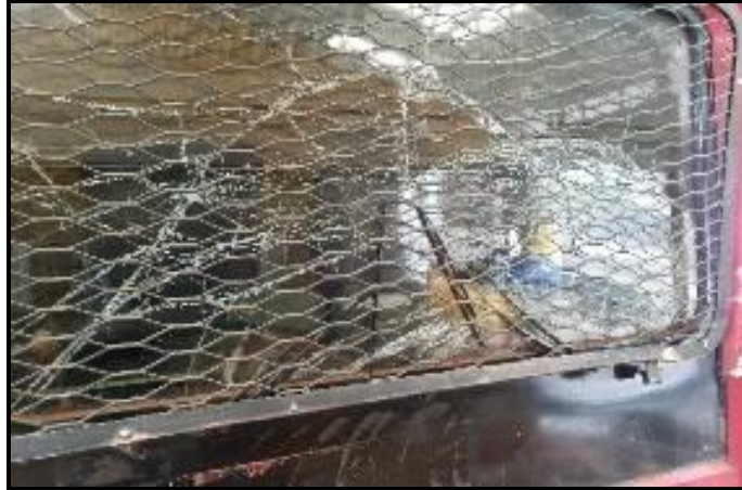
Gambar 5. Kaca kabin bagian depan dan pelindungnya pecah dan rusak.
