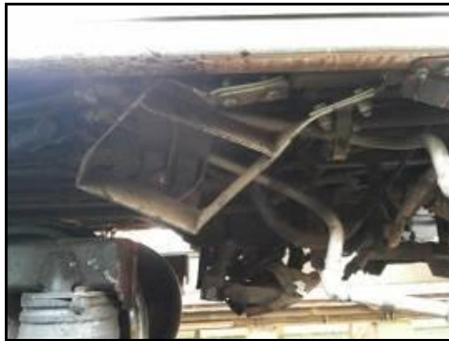
Gambar 8. Tangga masinis rusak kiri dan kanan
