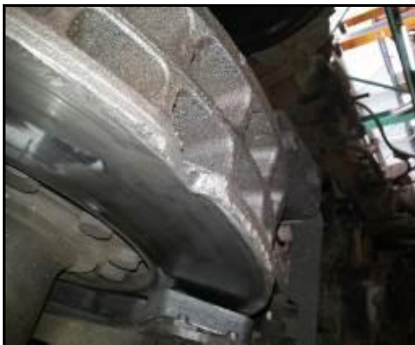
Gambar 9. Disc brake terkikis dan permukaan disc tergores
