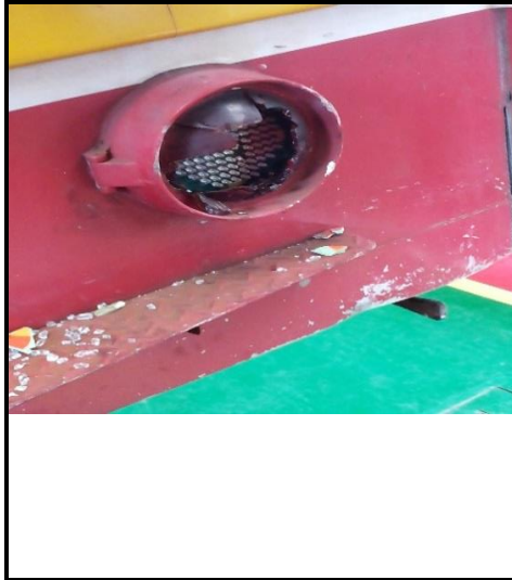
Gambar 12. Tutup lampu dan lampu semboyan 21 pecah
