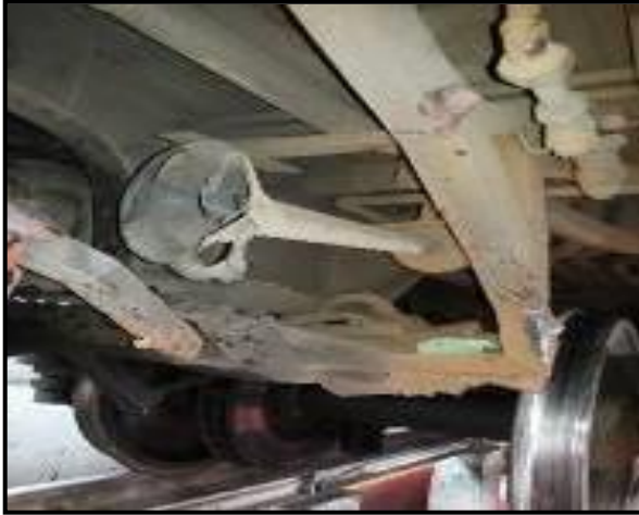
Gambar 7. Unit ATS terlepas dan horn rusak
