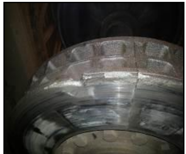
Gambar 9. Disc brake terkikis dan permukaan disc tergores
