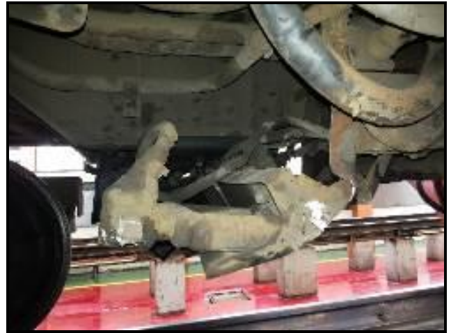
Gambar 7. Unit ATS terlepas dan horn rusak
