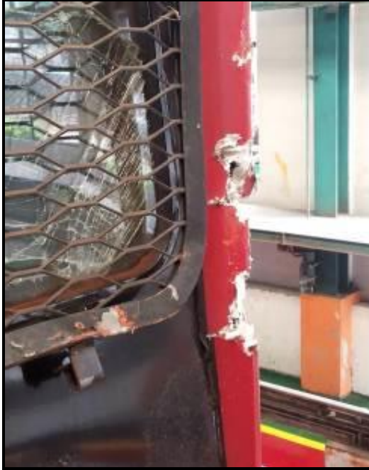
Gambar 10. Body bagian depan sebelah kiri rusak
