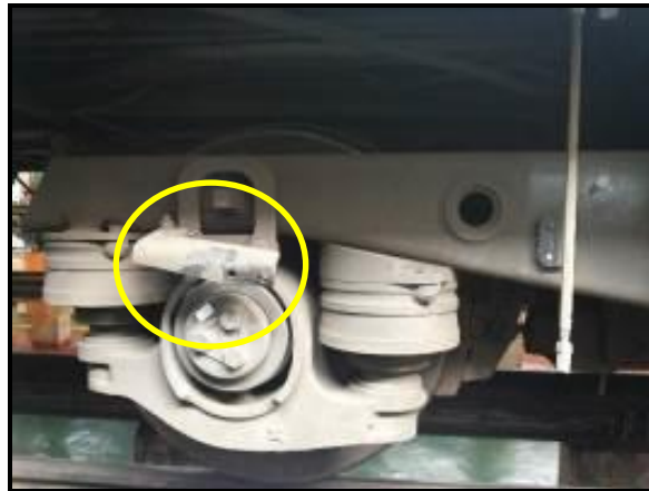
Gambar 15. Leveling valve patah 1 buah.
