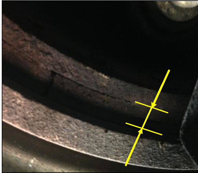
Gambar 5. Kondisi kanvas rem roda kiri – belakang cukup tebal.
