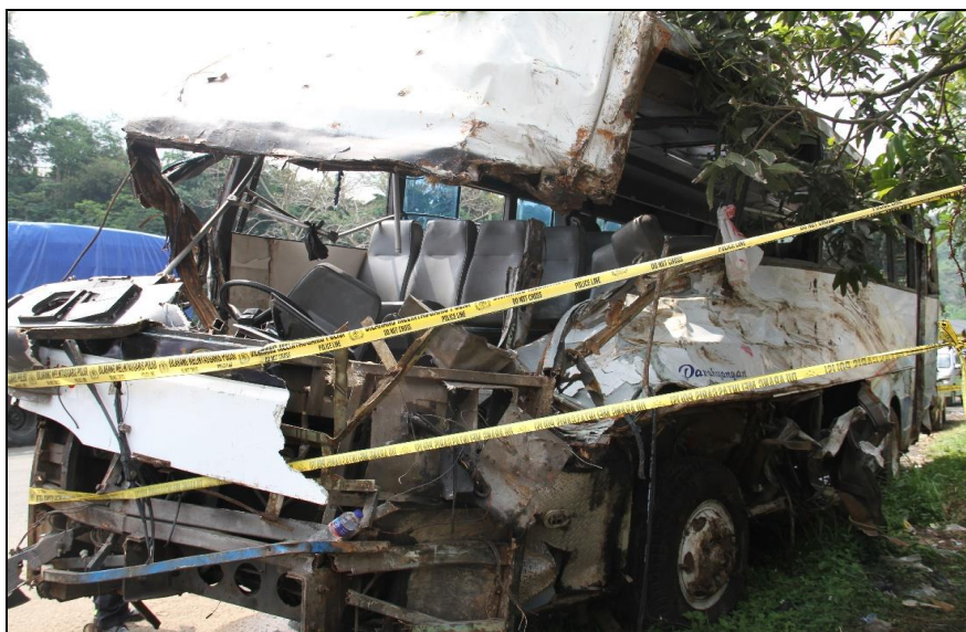
Gambar 10. Terjadinya korosi pada superstructure yang mempengaruhi pengurangan survival space akibat benturan
