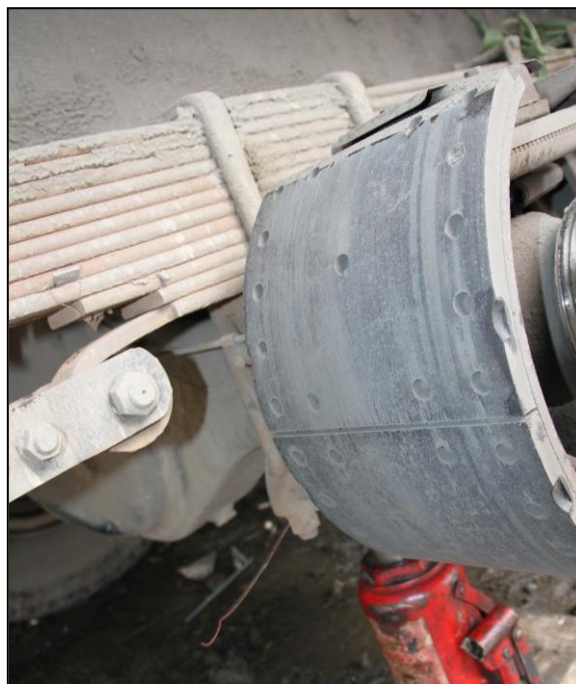
Gambar 8. permukaan kampas rem roda kanan – belakang tertutup lapisan kotoran
