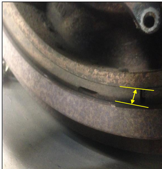
Gambar 4. Ketebalan kanvas rem roda kanan – depan masih cukup tebal.
