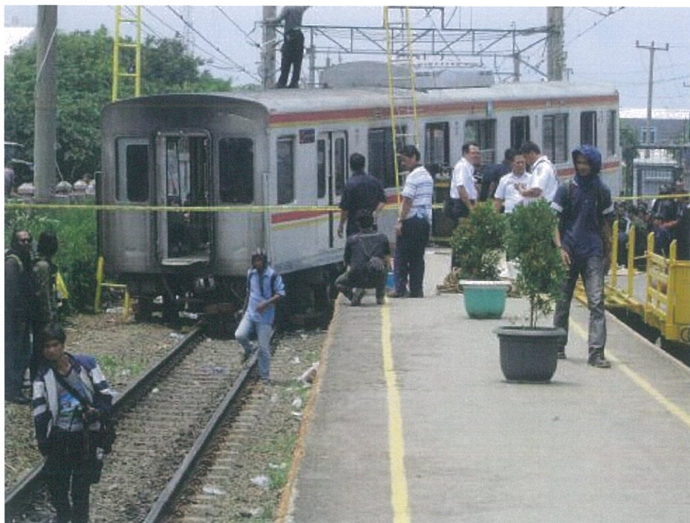
Gambar 2. KL1 05307 melintang antara jalur II dan jalur I dan menabrak peron St. Cilebut
