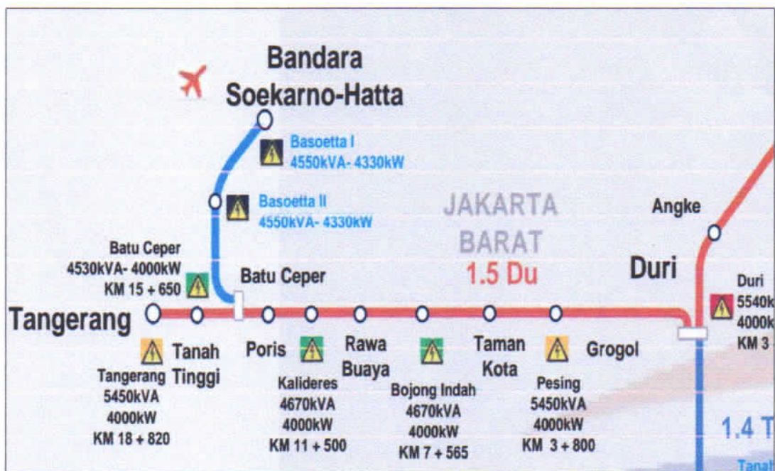
Gambar 2. Posisi Sub Station Listrik Aliran Atas di St. Batuceper
