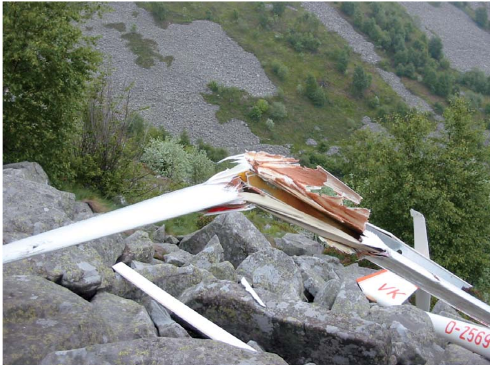
Foto n. 6: danni da impatto sul bordo d'ingresso della semiala destra.
