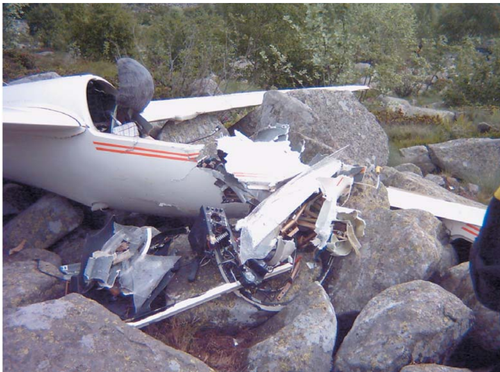
Foto n. 4: danni alla fusoliera anteriore ed alla cabina di pilotaggio.
