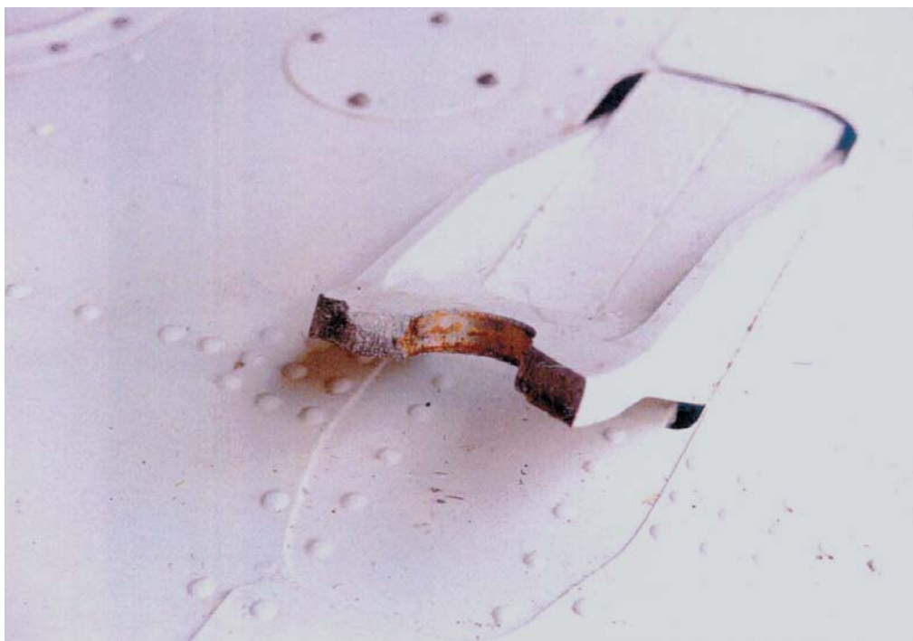
Foto n. 7: rottura attacco sub-alare destro.
