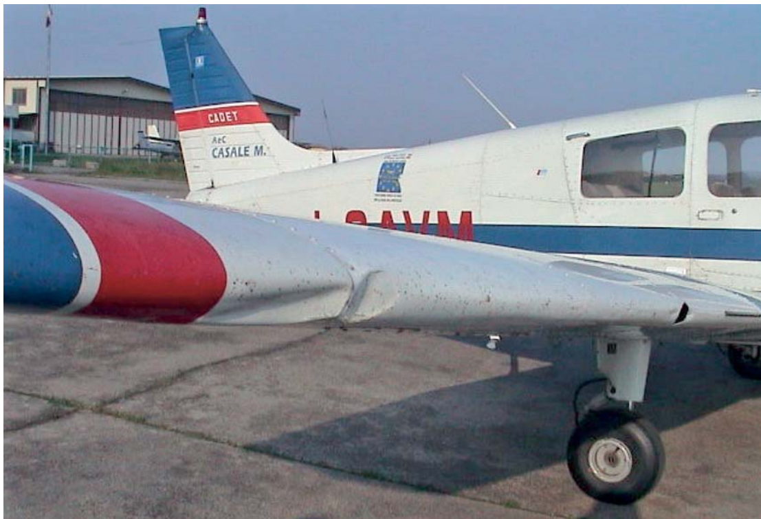
Danni alla semiala destra dell'aeromobile PA-28 I-CAVM.
