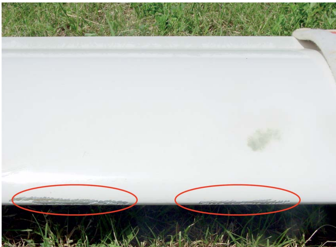
Danni sulla semiala.
