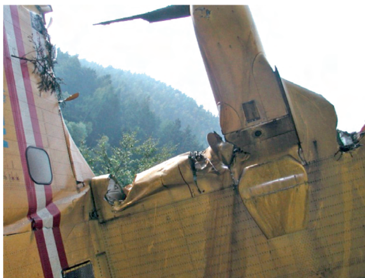
Foto n. 5: segni di impatto sul bordo di attacco semiala sinistra.
