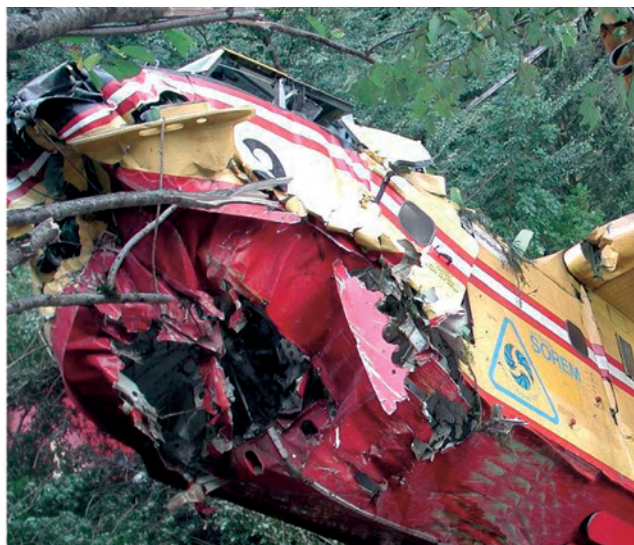
Foto n. 6: danni a carico della parte anteriore della fusoliera.
