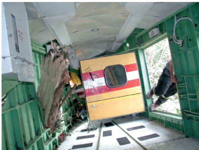
Foto n. 3: sfondamento della fusoliera posteriore da parte di un albero.
