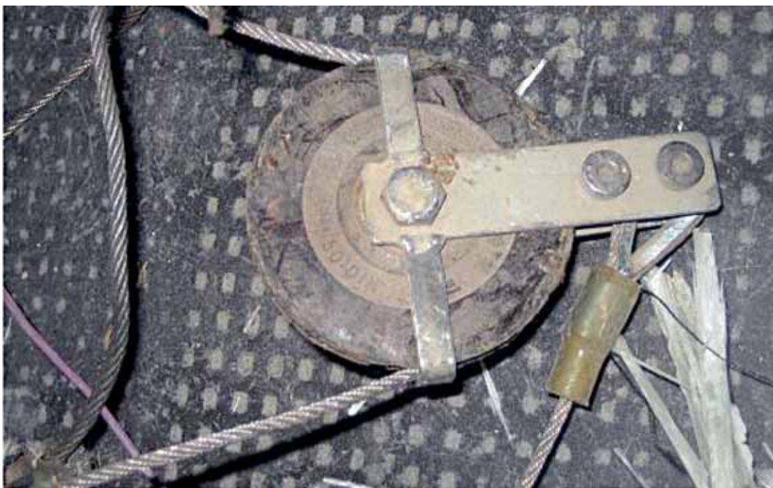
Foto n. 9: sistema carrucola-cavo della pedaliera.
