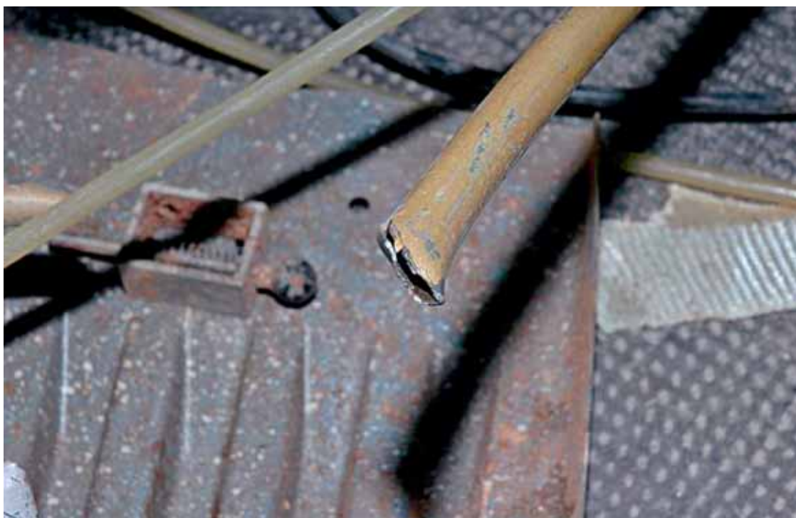
Foto n. 12: rottura asta di rinvio.
