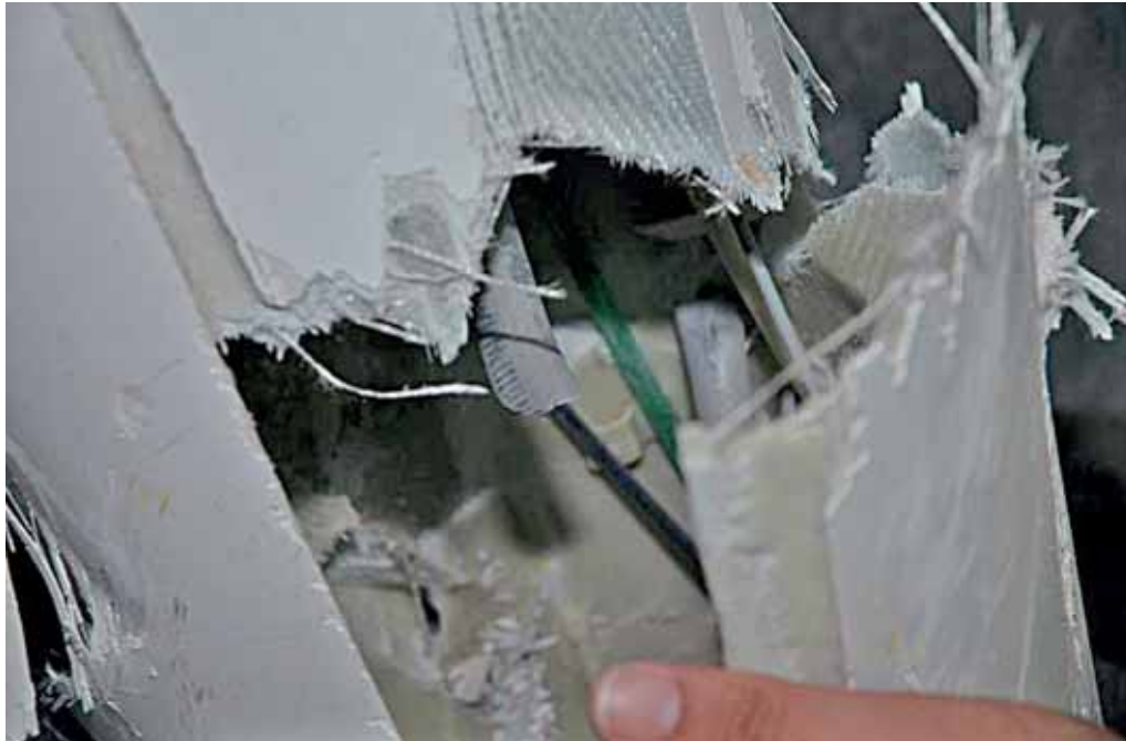
Foto n. 15: rottura asta di rinvio del timone di direzione.
