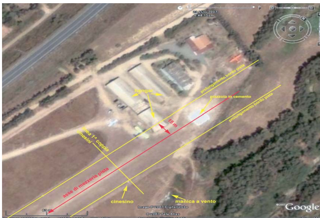
Disposizione strutture in testata 19.
