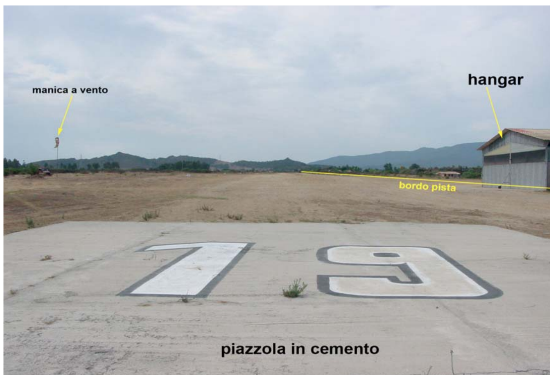
Piazzola segnaletica in testata 19.
