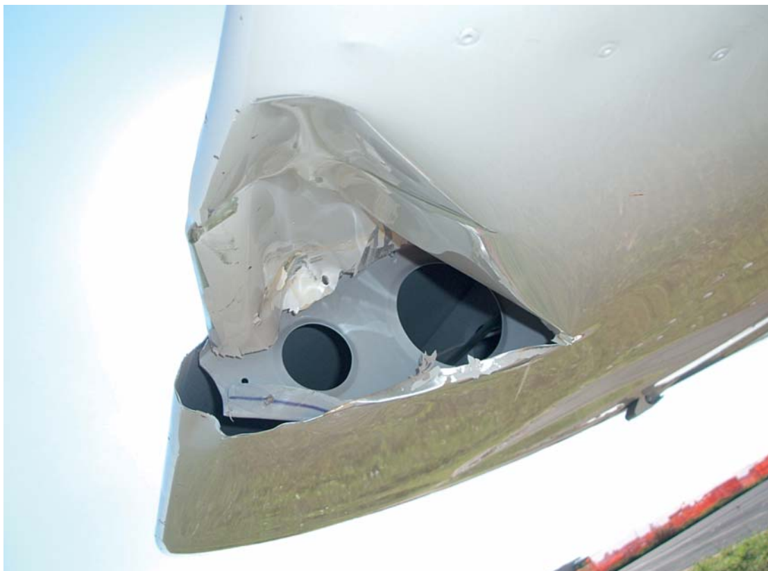
Particolare dei danni sul bordo di attacco.
