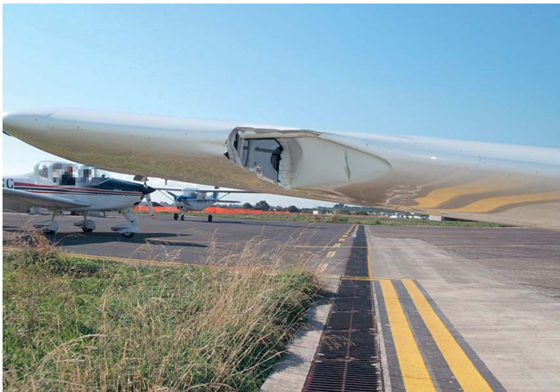
Estremità alare destra con lacerazione del bordo di attacco.
