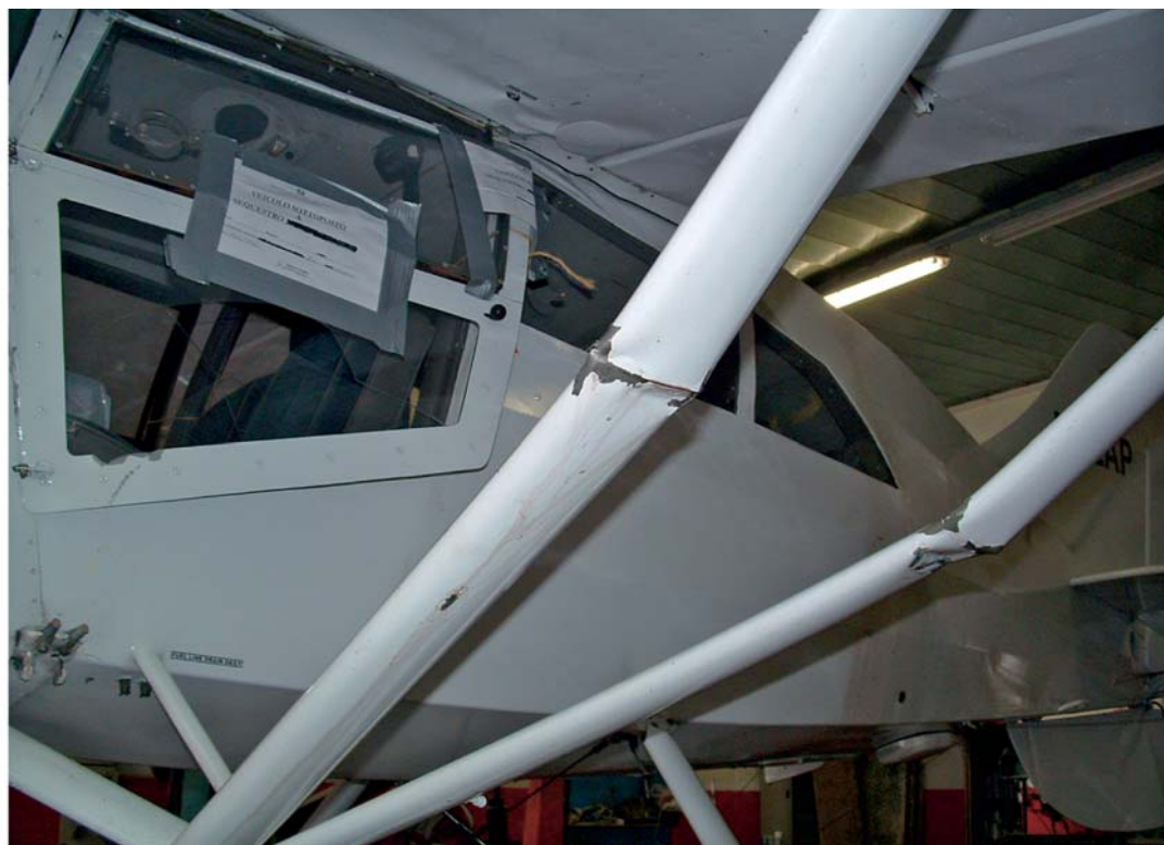
Particolare delle aste di controventatura semiala sinistra.
