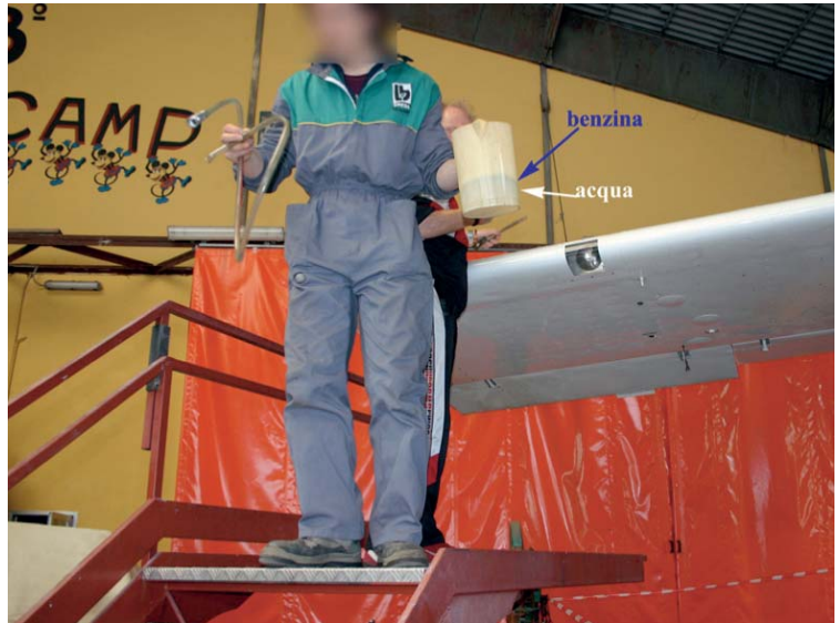
Foto n. 4: ispezione serbatoio destro.
